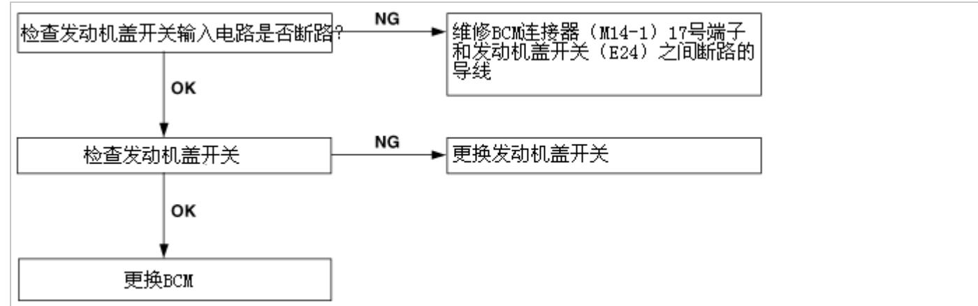
3. 在警戒状态打开车门时,不发出警报。 (后备箱门和发动机盖打开时,发出警报。)
